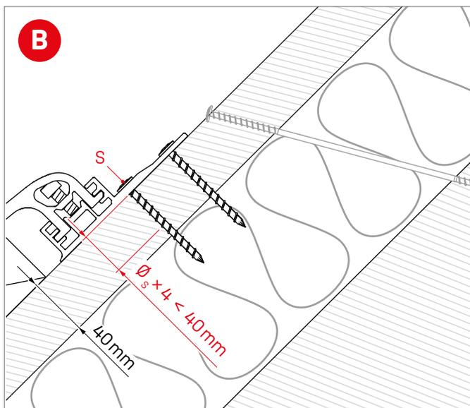
Falls eine Aufdachdämmung mit ausreichend druckfesten Dämmstoffen vorhanden ist, muss die Schraubenlänge einer Vollgewindeschraube so gewählt werden, dass die Mindesteinschraubtiefe der Schraube in der Konterlatte eingehalten wird. Es empfiehlt sich die Dachhaken in ausreichend dimensioniertes Holz zu befestigen.
