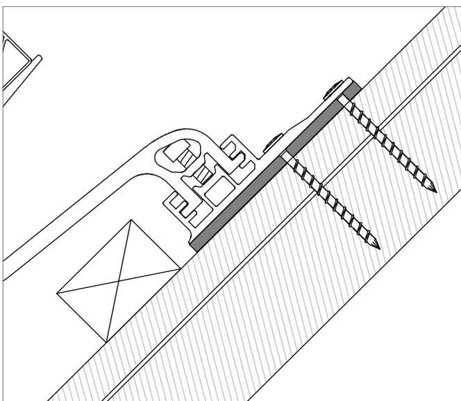
Falls der Dachhaken zum Höhenausgleich unterlegt wird, darf die Unterlage max. 4 mm hoch sein (z. B. Ausgleichsplatte, Artikelnr. 2002332), damit kein Biegemoment auf den Schraubenschaft entsteht.
