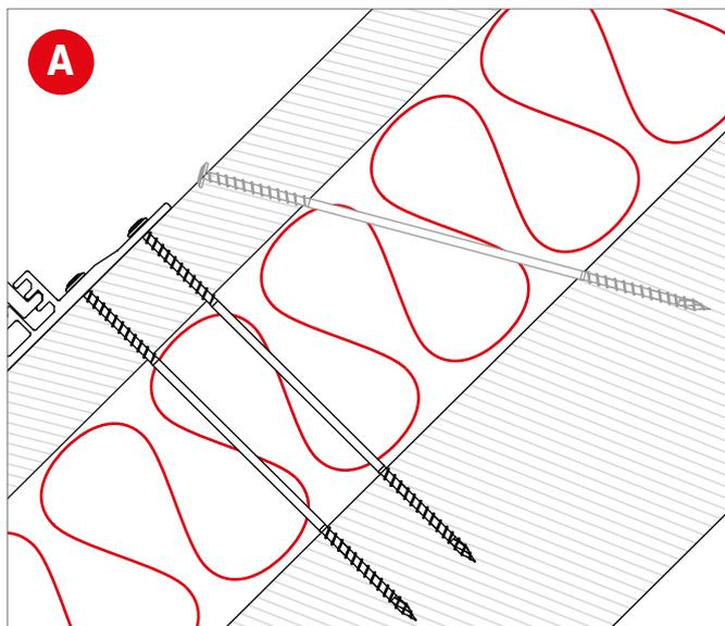
Bei der Befestigung von PV-Dachhaken auf Dachsystemen mit vorhandener Aufsparrendämmung sollte das Setz- und Schwindverhalten von Dämmstoff und Konterlattung berücksichtigt werden.
