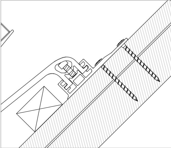
Es müssen immer mindestens 2 Schrauben für die Befestigung eines Dachhakens auf der Holzunterkonstruktion verwendet werden. Die Schrauben dürfen mit Vorbohren oder ohne Vorbohren verschraubt werden.
